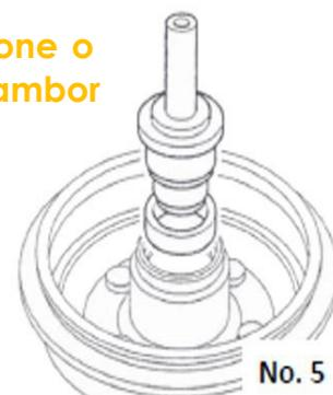
4) Aplique um pouco de graxa nas bordas do retentor antes de montá-lo no tambor. Nota: O KIT NTN-SNR é fornecido com retentor com abas que impede que ele seja montado no lado errado e oferece uma superfície para o apoio adequado da ferramenta de montagem. (nº 6). O retentor fornecido neste KIT é compatível para a substituição de um retentor sem abas sem prejuízo para a aplicação.
